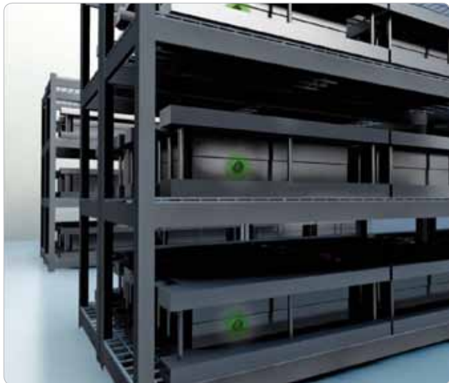
Obr. 5 Pripojením RFID dátových nosičov na formy alebo lisovacie matrice možno sledovať a ukladať rôzne parametre týkajúce sa nastavení, používania, výkonov údržby či zhody súčiastok.
