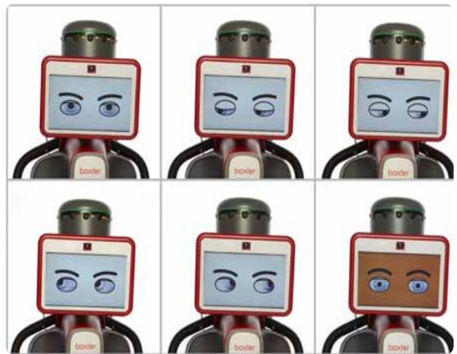
Obr. 23 Robot Baxter od firmy Rethink Robotics, ktorého ramená človek nastavuje – ukáže mu, ako nimi pohybovať. Zároveň má tvár a môže meniť jej výraz, čo smeruje oproti iným robotickým manipulátorom k prirodzenejšej spolupráci s človekom.
