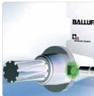
Obr. 3 Nástroje rôznych obrábacích a iných strojových zariadení možno vybaviť RFID dátového nosiča s cieľom sledovať a zaznamenávať veľkosť opotrebenia (od nastavených začiatočných podmienok), parametre nastavenia, využívanie a údaje o životnosti nástroja.
