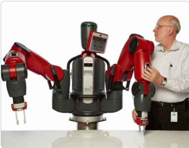
Obr. 23 Robot Baxter od firmy Rethink Robotics, ktorého ramená človek nastavuje – ukáže mu, ako nimi pohybovať. Zároveň má tvár a môže meniť jej výraz, čo smeruje oproti iným robotickým manipulátorom k prirodzenejšej spolupráci s človekom.
